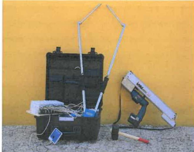
Figura 1: Equipamentos utilizados nos Estudos de Avaliação de Risco (tomógrafo, resistógrafo e martelo de borracha).
