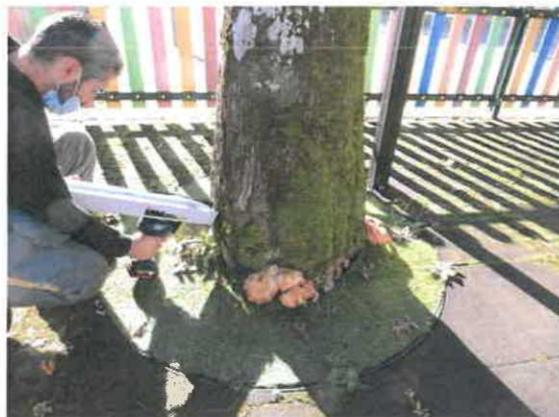
Figura 2: Exemplo da utilização do resistógrafo para análise da resistência biomecânica do tronco.
