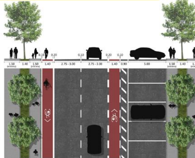
2.3 Corredor ciclável unidirecional com estacionamento transversal.
