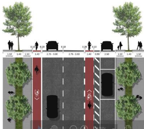
2.4 Corredor ciclável unidirecional com estacionamento longitudinal.
